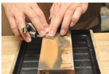
(左) 前後方向に動かして刃裏を研ぐ。(右) 横に動かしながら前後に移動する。どちらでも構わない。
