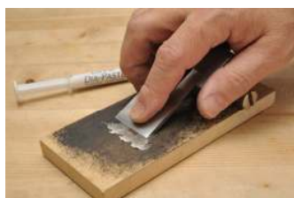
左：MDF 板にダイヤモンドペストを塗り、研磨している。右：刃裏も研磨した。鏡のように 10 円玉がくっきり写り込んでいる。
