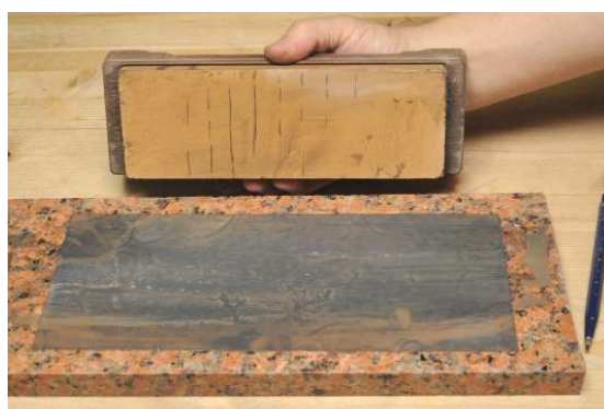
水をつけたサンドペーパーを定盤に置くと吸い付いて砥石でこすっても動かなくなる。サンドペーパーは #120 前後を試し、自分の砥石に合った番手を見つける。
