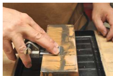
(左) 前後方向に動かして刃裏を研ぐ。(右) 横に動かしながら前後に移動する。どちらでも構わない。
