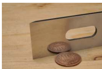
左：MDF 板にダイヤモンドペストを塗り、研磨している。右：刃裏も研磨した。鏡のように 10 円玉がくっきり写り込んでいる。
